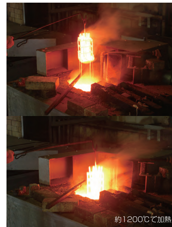
熱処理は塩浴炉を設備。個々の製品に最適な条件で焼入れ・焼戻しを行っています。
