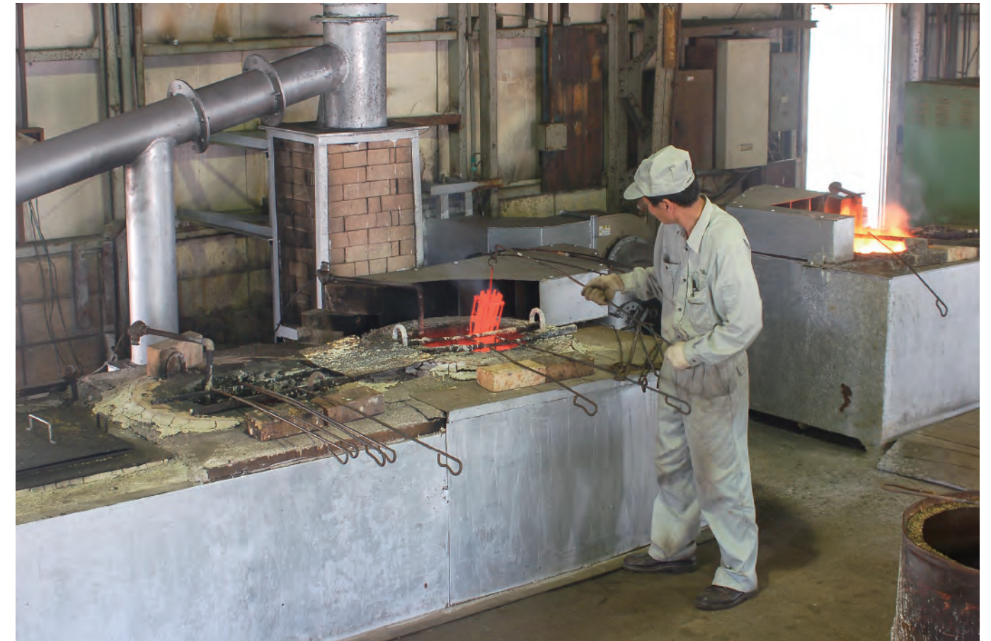
熱処理は塩浴炉を設備。個々の製品に最適な条件で焼入れ・焼戻しを行っています。
