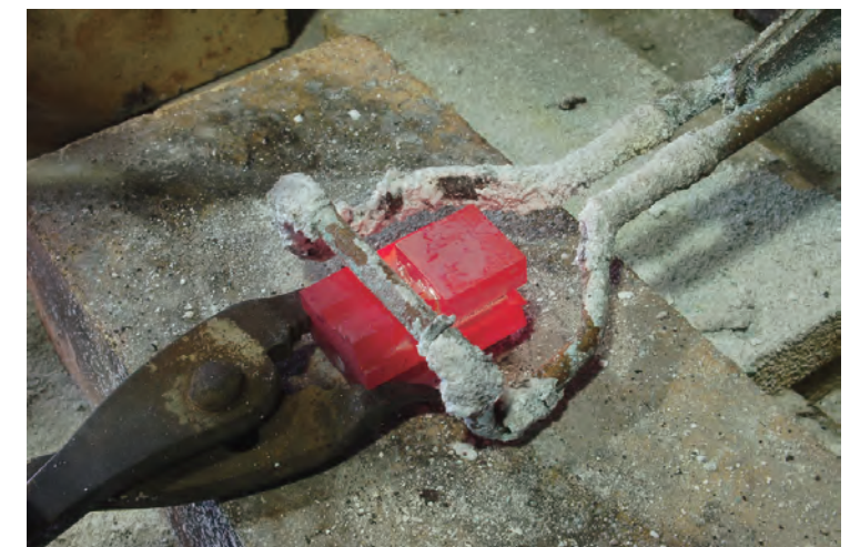
ロー付けは高周波誘導加熱により行っています。
