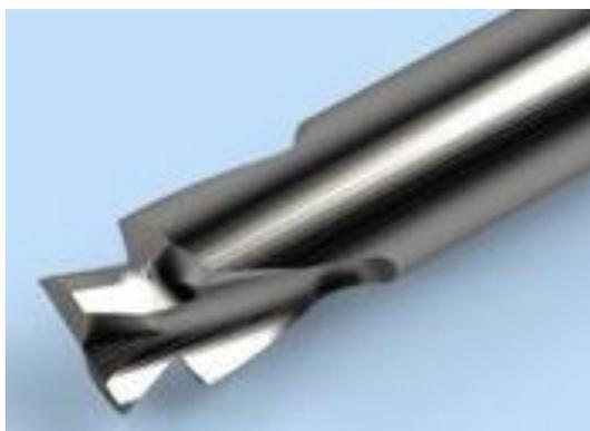
アリ溝加工用エンドミルは、シールパッキンの溝形状がアリ溝形状の場合に使用します。このエンドミルは、仕上げ加工まで行わなくてはならない為、被削材と加工条件に合ったコーティング膜種を選定することが重要です。
