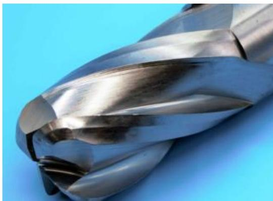
ラジアスエンドミルとは、スクエアエンドミルの底刃コーナー部をR状にしたエンドミルをいいます。また、コーナーRエンドミルなどとも呼ばれます。ラジアスエンドミルは切削加工した縦横の面と面の境にRができるためそのような仕上げを求められたときに使用します。また、スクエアエンドミルでコーナーがチッピングし易い時にもラジアスエンドミルを使う事で、コーナーのチッピングを低減させる事が可能です。
