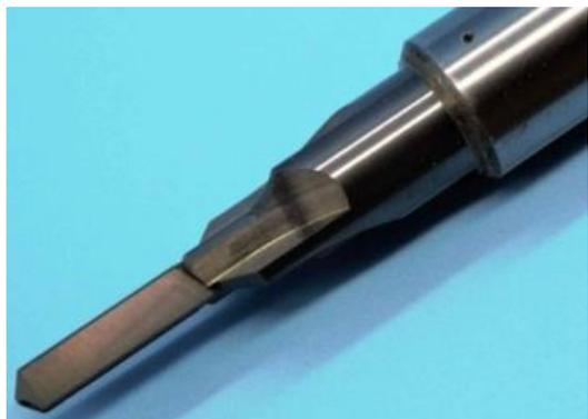
段付きリーマは、多段穴仕上げに用いられるリーマです。スパイラルリーマとは違い、名前の通り刃部が段付き形状になっていることにより、径が異なる複数の下穴を一度に加工することができます。これにより、加工工程の集約化を実現できます。段付きリーマを製作するためには、加工する穴の寸法に合わせた各段の径や長さを決め、特注での製作が必要となります。そのため、試作品などの加工で使用されることは少なく、多くは量産加工をする際に使用されます。これにより、段付きリーマのメリットを最大限に活かすことができ、加工工程の集約化によるコストダウンを実現できます。
