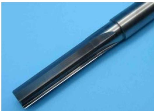
こちらは自動車業界で使用されるサイズがφ10×95の超硬製6枚刃テーパリーマです。ご依頼いただいたお客様は海外製のテーパリーマを使用しており、精度が安定しないために提案して欲しいとのことでした。株式会社東鋼では加工条件に合わせて溝形状やマージンを適切な寸法に設定しました。その結果、テーパ部の加工精度が上がり工具寿命が30%向上しました。株式会社東鋼では、工具寸法設定や工具形状を総合的に検討した工具設定を行っております。
