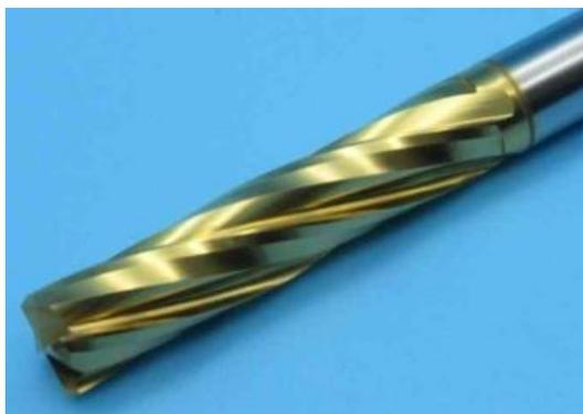
こちらは自動車業界で使用されるサイズがφ8×80のハイス製4枚刃リーマです。ご依頼いただいたお客様のご要望として、コーティング付きで刃径公差レンジ0.005以内に抑えたリーマを欲しいとのことでした。特殊精密切削工具.comではコーティング膜厚を薄膜コーティングで設定し、公差レンジ0.005以内に抑えてご提案しました。その結果、ワーク寸法に対して、安定した加工が出来ました。株式会社東鋼では、刃径公差レンジ0.005でのコーティング付きリーマの製作が可能です。
