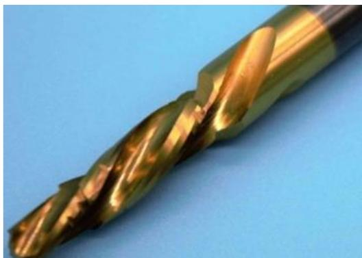
スパイラルリーマは、ねじれ溝によって切りくずの排出性を向上させ、ビブリの発生を抑制するリーマです。スパイラルリーマは通常右刃右ねじれで、切れ味と切屑の排出性が良く、特に加工硬化が著しく粘りのある銅やステンレスの加工に適しております。ストレートリーマと比べて切削抵抗が少なくなるので送り速度が上げられてリードタイムの短縮が図れます。また、段付き穴の加工にも使用出来、加工工程の集約化によるコストダウンも実現できます。
