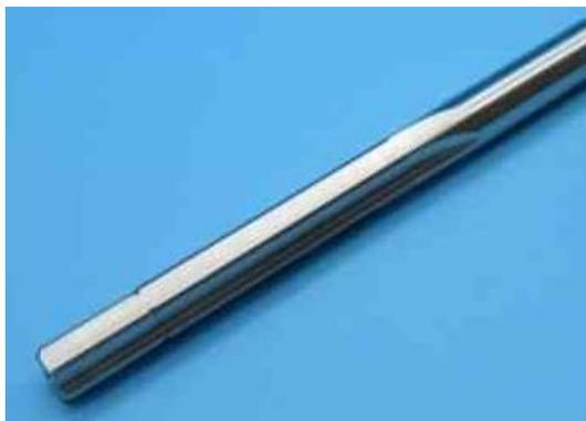
こちらは自動車業界で使用されるサイズがφ7.988×φ6.35×114のハイス製パイロット付リーマです。ワークの面粗度を改善したいとのご依頼をいただきました。株式会社東鋼においては面精度の悪化を誘発しているねじれ角やマーヅンを見直しました。その結果、面粗度が良くなり、メーカーでの品質検査も合格出来ました。株式会社東鋼では、リーマの設計の要であるねじれ角、マーヅンをワーク材質や加工条件に合わせて設定するノウハウを多数保有しており、すべてお客様の要望に沿って開発・製造したオーダーメイド工具を製作します。
