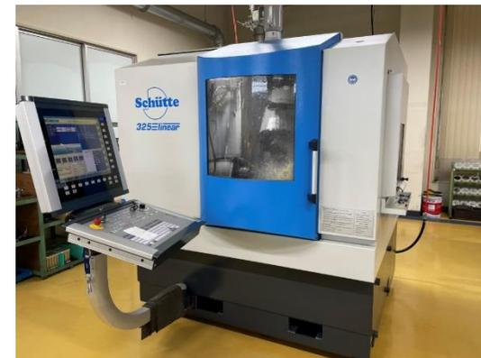
高精度5軸CNC研削盤
