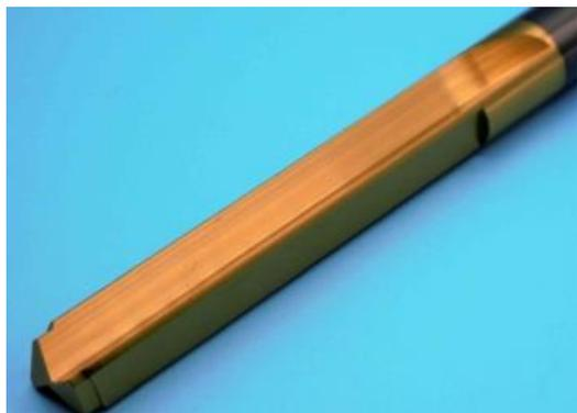
バニッシングリーマは、下穴の加工表面をバニッシュ効果により面粗度を向上させる為のリーマです。2枚の切れ刃で加工面を削り加工径を仕上げ、残りの2枚のマーヅンにより加工面をバニッシュすることで面粗度を向上させます。また、高い真円度を必要とする穴や同軸度を必要とする多段穴の仕上加工にも向いています。
