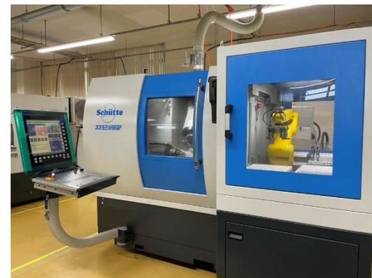
高精度5軸CNC研削盤
